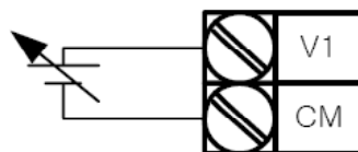
Zewnętrzne źródło sygnału 0~10
